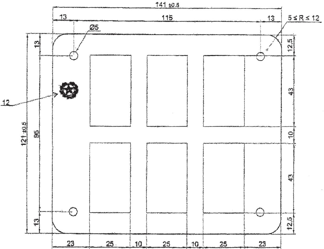
Raggio di curvatura della targa imbutita: 5 mm.  $5 \leq R \leq 12$  mm.
