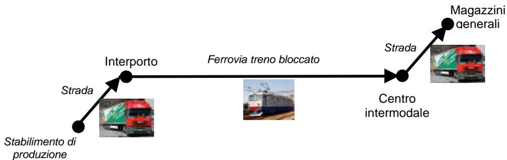
Fig. 5.3 – Esempio di ciclo plurimodale strada-ferrovia
