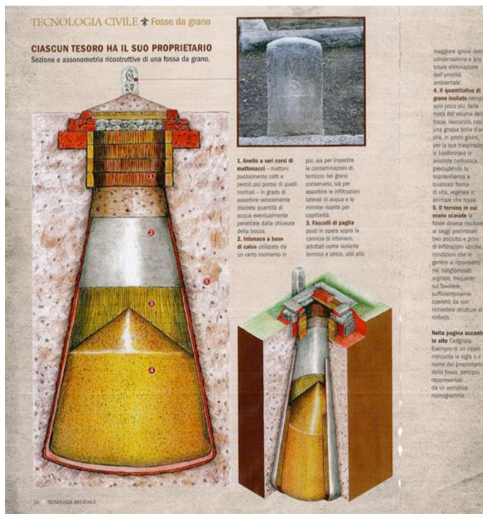
Fig. 48 Sistema di costruzione di una delle fosse di Cerignola (da RUSSO 2018, p. 26)
