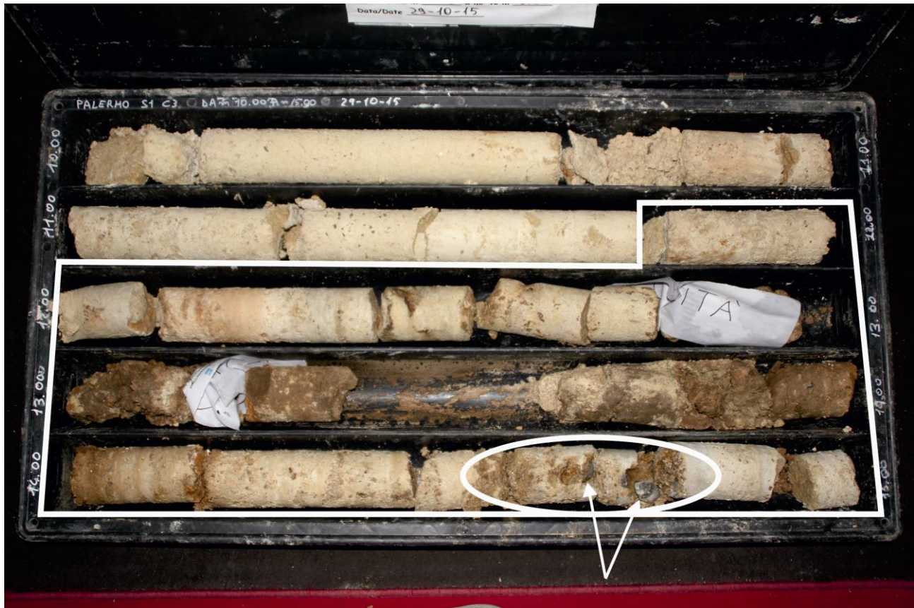
Fig. 16 Calcarenite conglomeratica intercettata nel carotaggio S1, ad una profondità compresa tra 11.75 e 15.25 m. Le frecce indicano i caratteristici ciottoli inclusi nella matrice calcarenitica (©ARS)
