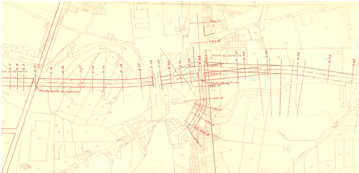
Fig 26 a Planimetria generale del progetto realizzato, che evidenzia la rettificazione di buona parte del corso inferiore dell'Oreto, compresa la modifica del tratto interessato dal ponte delle Teste
