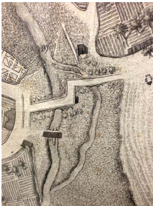
Fig. 3 Planimetria dell'area del passaggio dell'Oreto in cui è riconoscibile la viabilità fino al 1786, attraverso l'intero ponte normanno, la rampa ortogonale ed il ponte minore sul ramo laterale del corso d'acqua (Anito-Villabianca 1777). Si nota un ulteriore ponte a valle, grafi-camente raffigurato in maniera assai diversa, probabilmente perché realizzato in legno
