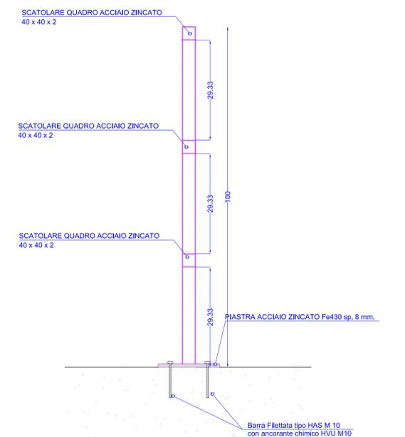
SCHEMA TIPO IN PIANTE E SEZIONE delle RINGHIERE
