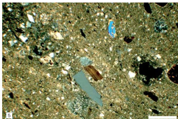
Fig. IV-4 Microfotografia al microscopio polarizzatore del campione P/41 (nicol incrociati; barra dimensionale = 0.5 mm).
