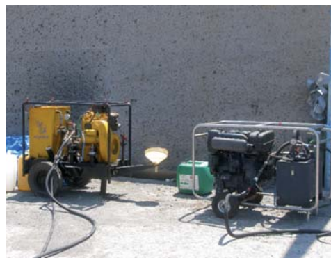
Fig. 15 Sistema di pompaggio sorbone oleodinamiche.
