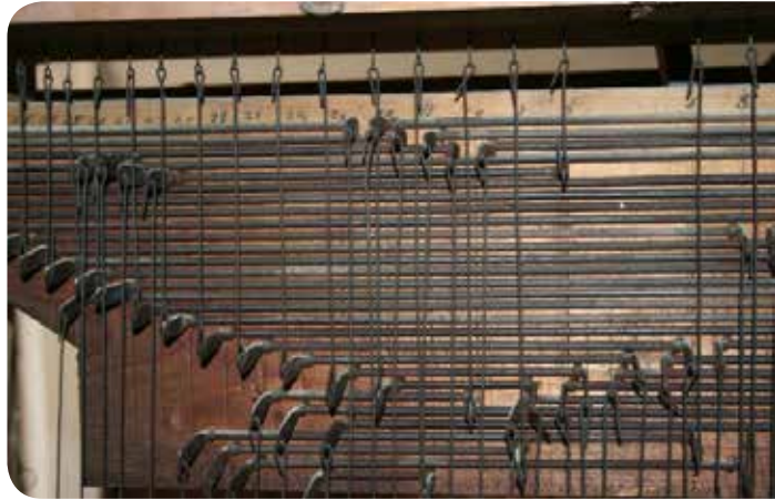
11 Dal basso: tastiera, tiranti, tavola di riduzione con catenacciatura in ferro, somiere con portelle aperte, molle e ventilabri
